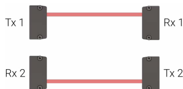
Corretta installazione senza CODE
